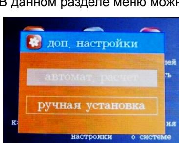
В автоматическом режиме ресурс системы или количество дней до регенерации рассчитывается автоматически на основании введенных значений объема смолы, жесткости воды, расхода соли на регенерацию и количества потребителей.
