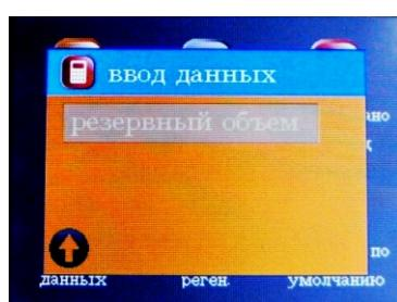
На основании введенных значений объема смолы, количества соли на регенерацию, скорости заполнения солевого бака, емкости системы и резервного ресурса клапан автоматически рассчитывает ресурс системы до регенерации.
