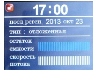
Экран показывает текущее время, день последней регенерации, тип регенерации. Синяя полоса показывает количество дней до следующей регенерации.
