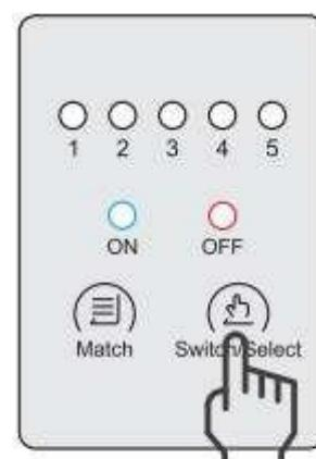
**Примечание:** При нормальных условиях эксплуатации короткое нажатие кнопки используется для переключения состояния главного регулирующего клапана on/off состояние.
