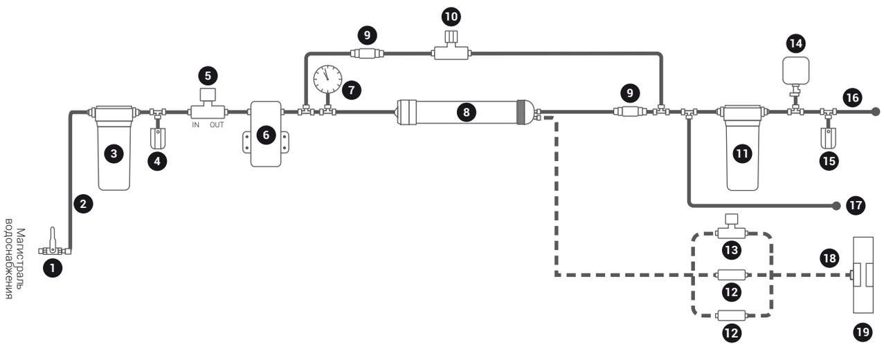
Пунктиром на схемах обозначена линия дренажа.
