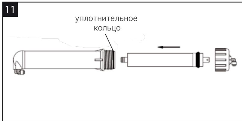
**После замены фильтрующих элементов проверьте герметичность подключений, подав воду на систему, и промойте систему, пропустив 5-10 литров воды.**
